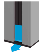
Embout de bas de coulisse : dessiné pour éviter l'accumulation d'eau ou de rosée
