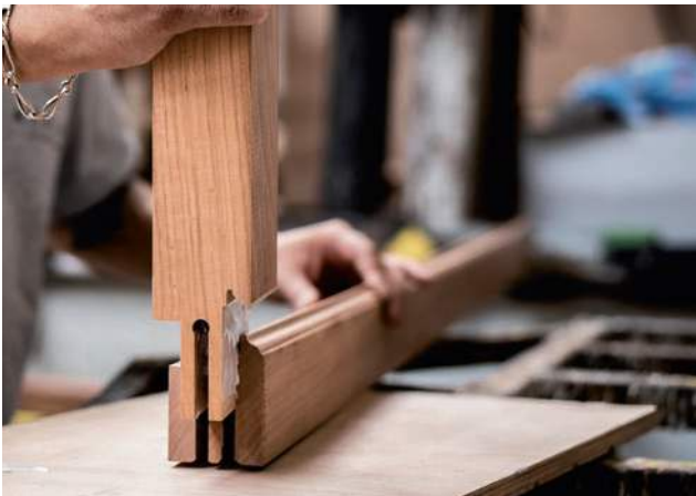
Assemblage des ouvrants par double enfourchement
